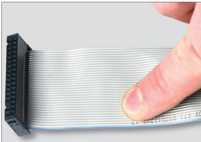
Figura 2. Los cables planos IDE tienen un cable de referencia destacado con un color, para orientarnos en la conexión.
