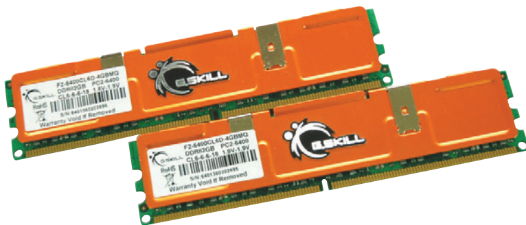
Figura 40. Los módulos de memoria RAM poseen características particulares como la frecuencia, la cantidad de contactos y la capacidad de almacenamiento.
