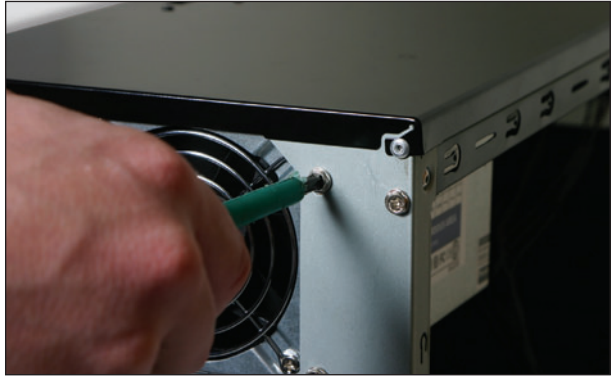
Figura 2. La fuente de alimentación lleva cuatro tornillos que la sujetan al gabinete, y es necesario colocarlos a todos.
