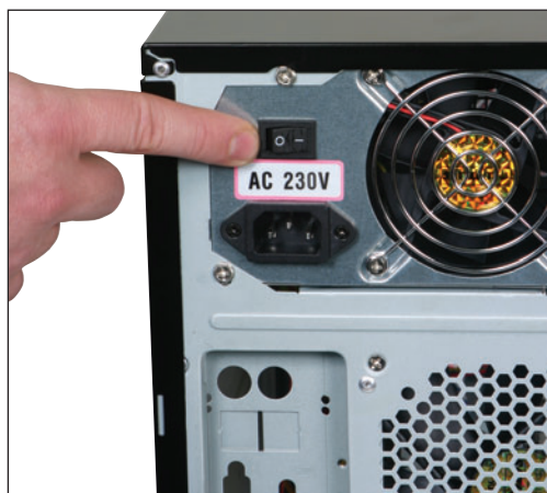
Figura 5. La tecla de la fuente tiene un círculo (apagada) y una línea (encendida). Muchos principiantes se olvidan de colocarla en ON y pierden tiempo en buscar una falla.
