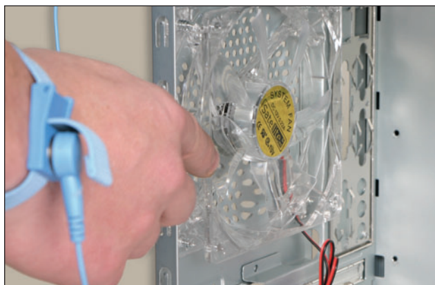
Figura 33. La función del cooler es extraer el aire viciado desde adentro del gabinete.
