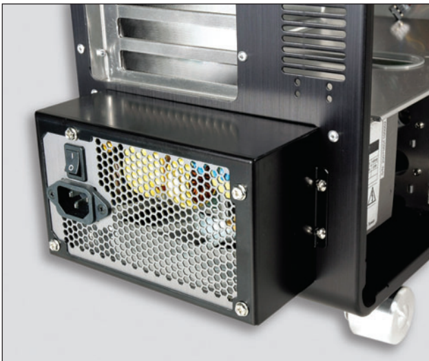
Figura 27. Una de las diferencias de los gabinetes con factor BTX es la disposición de la fuente de alimentación en la parte inferior del gabinete.
