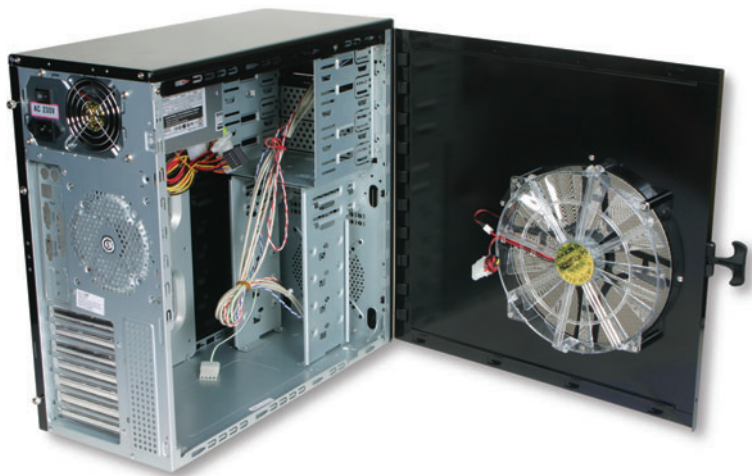
Figura 26. Es importante el modo en que se disponen los componentes en el gabinete y la renovación de aire para una buena refrigeración.
