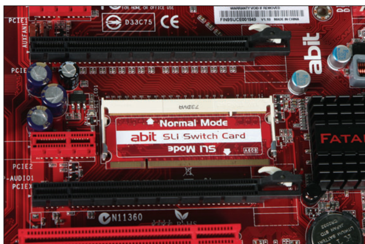
Figura 11. Ésta es la forma física de las ranuras (slot) para placas de video PCI Express 16X.
