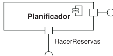
Figura 14.68 Notación de puerto de componente
