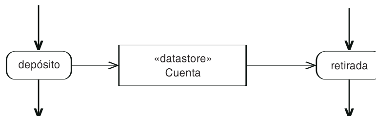
Figura 14.191 Nodo almacén de datos
